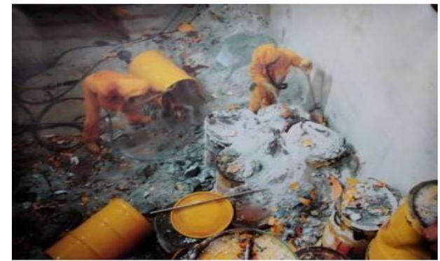
英国核集团 (British Nuclear Group) 曾尝试几个封装在水泥基体中的废树脂实验得知，树脂在纯普通硅酸盐水泥(OPC)的固化形式最初是获得令人满意的结果，但是，后来在仅仅几个星期后此固体碎成了粉末。
